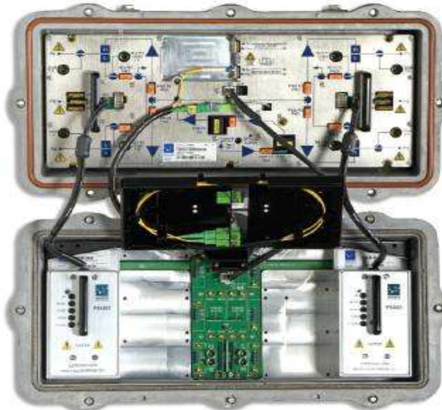
Figura 8 Nodo Óptico eléctrico.
