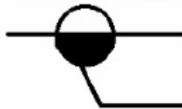
Figura 13 Símbolo de Acoplador Direccional.
